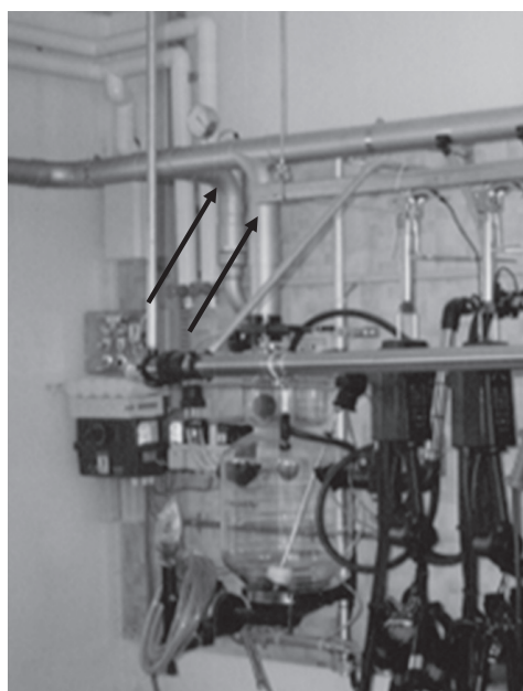
図31 1ライン方式配管 すべてが1本のポンプからの配管から分岐する1ライン方式 矢印は分岐部分を示す
