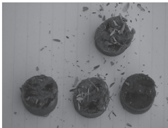
図8 パルセーター本体内部のフィルターの汚れ
